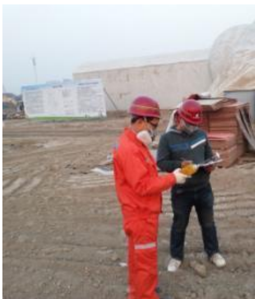
图 6.4-3 图手持光离子化检测器（PID）监测过程示意图
