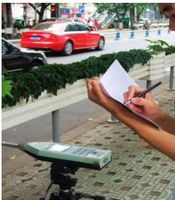
图 6.4-5 手持式分贝计监测示意图
